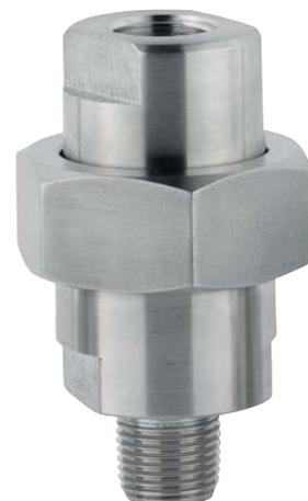
Druckmittler sind Trennvorlagen, die ein Eindringen von aggressiven, verschmutzten, heißen und viskosen Medien in das Messelement eines Druckmessgerätes verhindern. Die Membrane ist mit dem Druckmittleroberteil verschweißt. Ein Dichtigkeitstest gewährleistet eine zuverlässige Trennung des Prozessmediums vom Druckmessgerät. Das Druckmittleroberteil kann zu Reinigungszwecken demontiert werden. Dieses Merkmal, sowie die kompakte Bauform ermöglichen vielfältige Einsatzbereiche.
